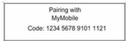
輸入所顯示的 SAP 通行密碼於行動電話（不要有空格）。行動電話 PIN 碼顯示在資訊娛樂顯示幕上。
