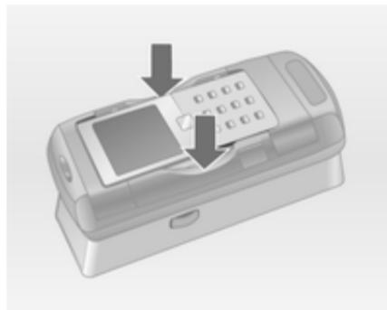
轉接器的側托架打開時，如上圖所示將行動電話垂直往下放到轉接器內，直到側托架卡入為止。
