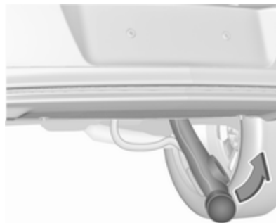
כשידית השחרור נמשכת החוצה והתפוח משתחרר, נשמע צליל זמזום התרעה
