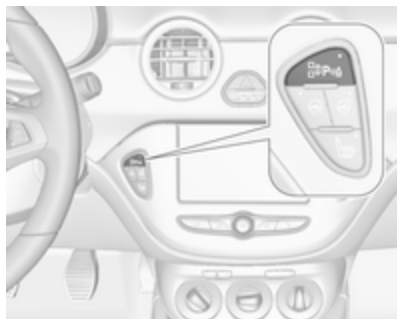
כשמחפשים מקום חניה, המערכת מוכנה לפעולה בלחיצה ארוכה על Ⓟ .
