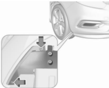
1. Déposer les vis extérieures du couvercle, comme indiqué dans l'illustration.
