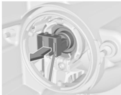
2. Retirer la douille de l'ampoule du boîtier du réflecteur.
