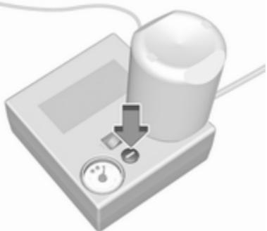
Si la pression des pneus prescrite n'est pas atteinte dans les dix minutes, démonter le kit de réparation de pneus. Avancer ou reculer le véhicule d'un tour de roue. Brancher à nouveau le kit de réparation des pneus et poursuivre la
