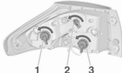
5. Retirer et remplacer l'ampoule en tournant la douille d'ampoule.
