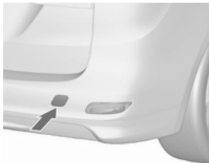
Insérer un tournevis dans la fente sur le bord bas courbe du capuchon. Dégager le capuchon en enfonçant avec précaution le tournevis vers le bas. Pour éviter tout dégât, il est recommandé de placer un chiffon entre le tournevis et le cadre.
