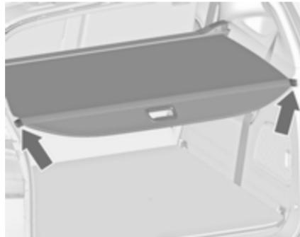
Tirer le cache-bagages par la poignée vers l'arrière et l'accrocher dans les logements latéraux.
