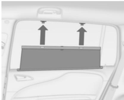
Pour réduire l'exposition au soleil de la deuxième rangée de sièges, relever le store en utilisant la poignée et l'encliquer sur le haut du cadre de porte.
