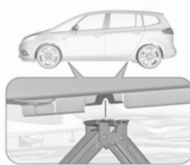
4. Vérifier que le cric est bien positionné sous le point de levage adéquat.
