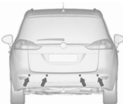
Quatre capteurs de stationnement à ultrasons sont présents dans chaque pare-chocs avant et arrière.
