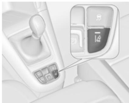
Le système d'avertissement de franchissement de ligne est activé en appuyant sur . La LED allumée dans le bouton indique que le système est activé. Quand le témoin du combiné d'instruments s'allume en vert, le système est prêt à fonctionner.
