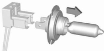
3. Retirer l'ampoule du connecteur enfichable en tirant.
