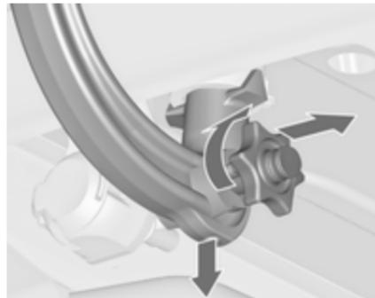
Ouvrir le volet de protection et tourner la clé en position
