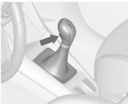
Marche arrière : le véhicule étant à l'arrêt, enfoncez la pédale d'embrayage, enfoncez le bouton de déverrouillage du levier sélecteur et engager le rapport.
