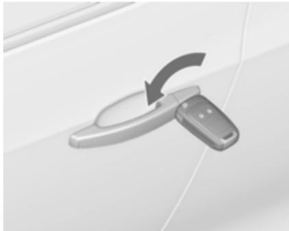
Déverrouiller manuellement la porte du conducteur en tournant la clé dans la serrure. Mettre le contact et appuyer sur pour déverrouiller toutes les portes, le coffre et la trappe à carburant. Le dispositif antivol se désactive en mettant le contact.
