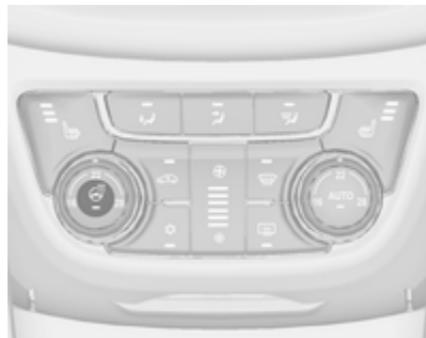
Activer le chauffage en appuyant sur . L'activation est signalée par la LED dans le bouton.
