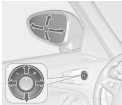
Selectionner le rétroviseur extérieur souhaité en tournant la commande vers la gauche (**L**) ou à droite (**R**). Régler le rétroviseur correspondant en inclinant la commande à quatre voies.
