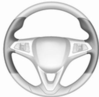
Les zones recommandées pour tenir le volant sont chauffées plus rapidement et à une température plus élevée que le reste du volant.
