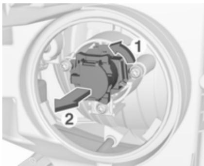
2. Faire tourner la douille de l'ampoule dans le sens antihoraire pour la désencliquer. Retirer la douille de l'ampoule du boîtier du réflecteur.
