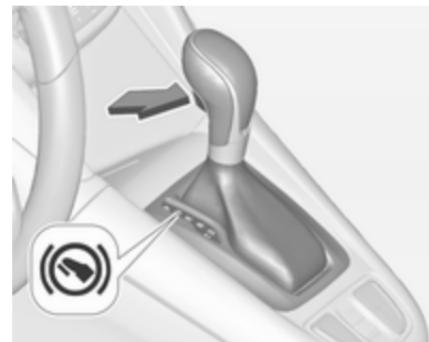
Le levier sélecteur est verrouillé en position **P** et ne peut être déplacé que lorsque le contact est mis, lorsque le
