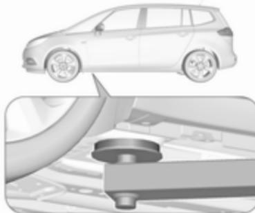
Position du bras avant du pont élévateur au niveau du soubassement.
