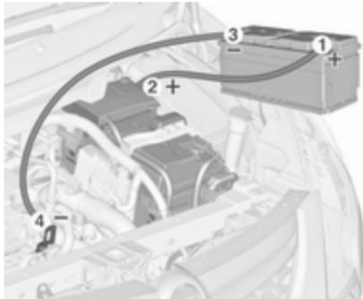
Séquence de raccordement des câbles :
