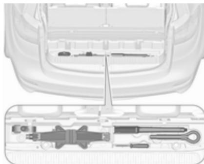
Certains outils, l'oeillet de remorquage (uniquement pour les véhicules avec roue de secours) et l'équipement de levage de véhicule sont rangés dans le rangement à l'arrière dans le plancher du coffre.
