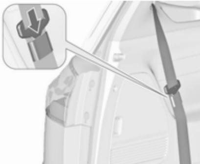
Avant d'ouvrir le cache-bagages, insérer le verrou plat de la ceinture de sécurité de chaque côté dans la pochette intégrée à la ceinture.
