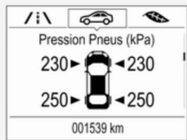
6. Appuyer sur **SET/CLR** pour lancer le processus d'appariement de capteur. Un message demandant d'accepter le processus doit s'afficher.
