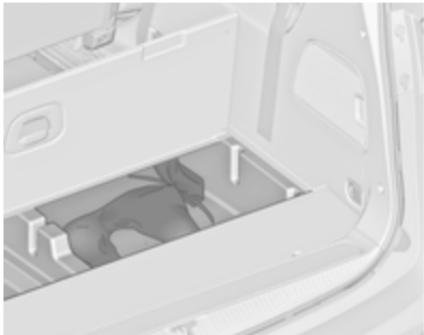
Sur la variante sans troisième rangée de sièges, des boîtes de rangement peuvent être trouvées sous le revêtement de plancher. Soulever le couvercle pour l'ouvrir.
