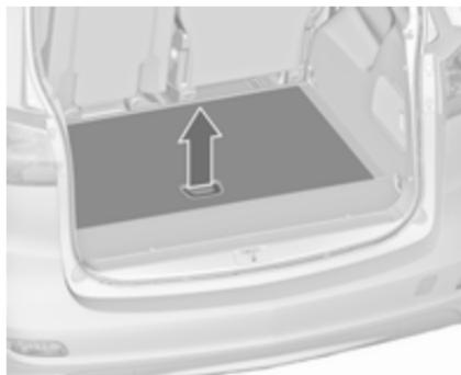
Sur les variantes sans troisième rangée de sièges, des boîtes de rangement peuvent être trouvées sous le revêtement de plancher. Pour ouvrir, soulever le revêtement et le replier droit derrière les sièges arrière.
