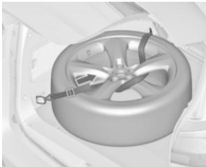
2. Placer l'extrémité libre de la sangle à travers l'anneau d'arrimage avant du côté gauche.
