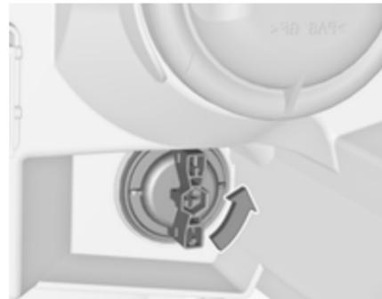
1. Faire tourner la douille de l'ampoule dans le sens antihoraire pour la désencliquer. Retirer la douille de l'ampoule du boîtier de réflecteur.
