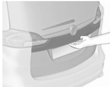
Après le déverrouillage, toucher le commutateur tactile sous la moulure du hayon et ouvrir le hayon.
