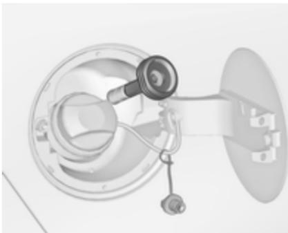
**Adaptateur ACME :** Visser l'écrou du pistolet de remplissage sur l'adaptateur. Abaisser le levier de verrouillage du pistolet de remplissage.
