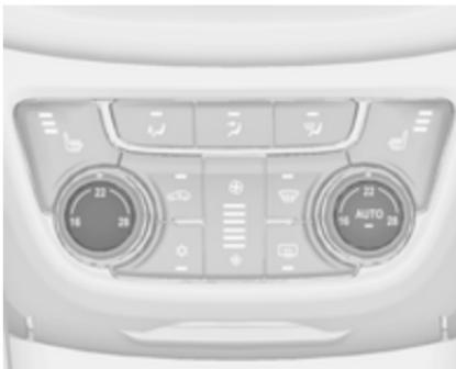
Si la température minimale **Lo** est réglée, le système de commande de climatisation fonctionne avec sa capacité maximale de refroidissement, si le refroidissement ☀ est activé.
