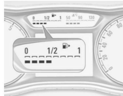
Affiche le niveau de carburant ou la quantité de gaz (GPL ou GNC) dans le réservoir en fonction du mode de fonctionnement.
