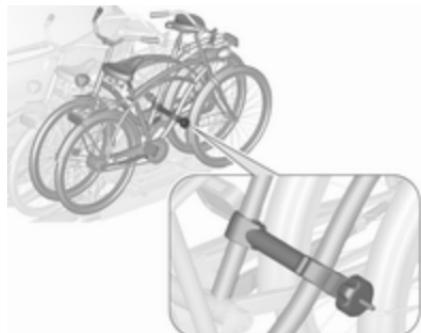
Utiliser l'étrier de montage court pour fixer le quatrième vélo. L'étrier doit être fixé entre les cadres du troisième et quatrième vélos.
