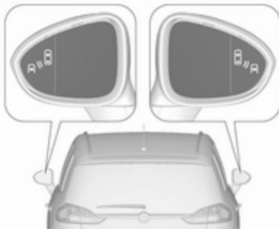
L'alerte d'angle mort latéral est activée lorsque le véhicule roule à des vitesses allant de 10 km/h à 140 km/h. Conduire à une vitesse supérieure à 140 km/h désactive le système, ce qui est indiqué par les symboles d'avertissement à faible luminosité sur les deux rétroviseurs extérieurs. Ralentir à nouveau éteindra les symboles d'avertissement. Si un véhicule est alors détecté dans la zone d'angle mort, les symboles d'avertissement s'allumeront normalement du côté approprié.
