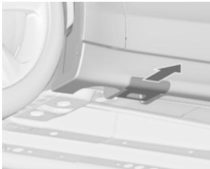
3. Certaines variantes peuvent avoir le point de levage par cric du véhicule recouvert. Éloigner le couvercle sur le côté.
