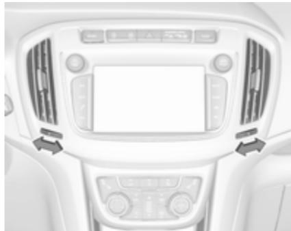
Pour ouvrir une bouche d'aération, tourner la molette sur I. Régler le débit d'air venant de la bouche d'aération en tournant la molette.
