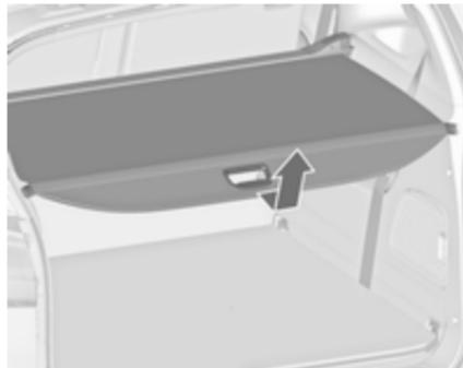
Retirer le cache-bagages des guides latéraux. Maintenir la poignée et guider le cache-bagages jusqu'à ce qu'il soit complètement enroulé.
