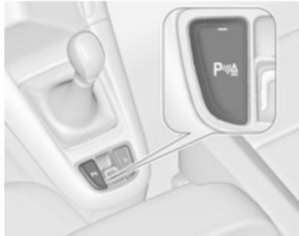
La désactivation manuelle est également possible. Pour cela, appuyer sur le bouton d'aide au stationnement  $P\triangle$ .
