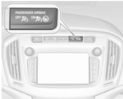
Si le témoin ON s'allume pendant environ 60 secondes après avoir mis le contact, le système d'airbags de passager avant se gonflera en cas de collision.
