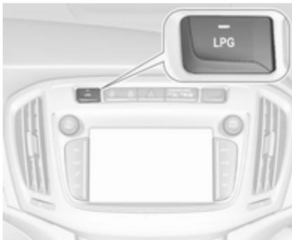
L'actionnement de **LPG** permet le basculement entre les modes de fonctionnement à l'essence et au gaz de pétrole liquéfié dès que les paramètres requis (température de liquide de refroidissement et régime moteur minimal) ont été atteints. Les exigences sont généralement satisfaites après environ 60 secondes (en fonc-
