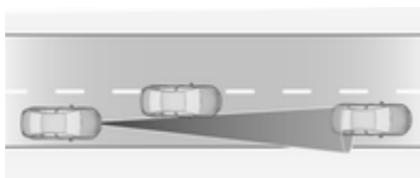
Si un autre véhicule entre dans la même voie de circulation, le régulateur de vitesse adaptatif considérera le véhicule lorsqu'il est complètement sur votre voie. Être prêt à agir et enfoncez la pédale de frein, si un freinage plus rapide est nécessaire.
