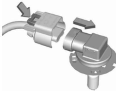
3. Dégager la douille d'ampoule du connecteur en enfonçant la patte de retenue.
