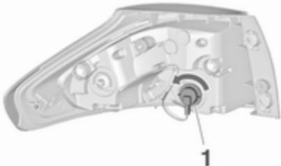
**Feux arrière avec diode électroluminescente (LED) pour les feux arrière et les feux stop**
