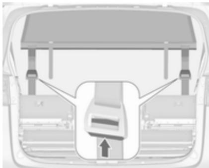
Pousser le bouton sur le tendeur pour relâcher la sangle des deux côtés. Détacher les crochets des anneaux. Décrocher les tiges du filet de sécurité des supports du cadre de toit. Rouler le filet et le fixer avec une sangle.
