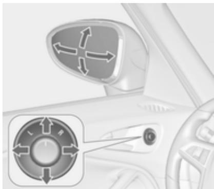
Sélectionner le rétroviseur extérieur souhaité en tournant la commande à gauche (**L**) ou à droite (**R**). Régler le rétroviseur correspondant en inclinant la commande à quatre voies.
