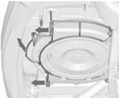
5. Lever le support de roue de secours et ouvrir les deux verrous à crochet.
