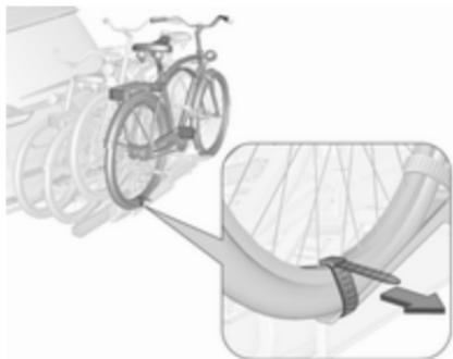
6. En plus, attacher les deux roues du quatrième vélo aux logements de roue en utilisant les sangles de serrage.
