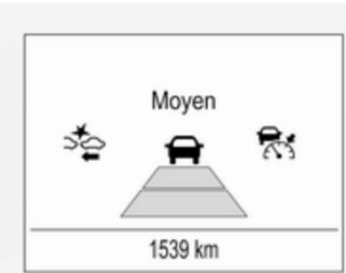
La distance vers l'avant sélectionnée est indiquée par les barres de distance remplies sur la page du régulateur de vitesse adaptatif.
