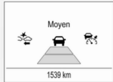
Il est à noter que le réglage de sensibilité de temporisation d'alerte est partagé avec le réglage de la distance vers l'avant du régulateur de vitesse adaptatif. Donc modifier la sensibilité de la temporisation d'alerte change le réglage de distance vers l'avant du régulateur de vitesse adaptatif.
