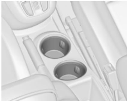
Les porte-gobelets sont disposés sur la console centrale entre les sièges avant.
