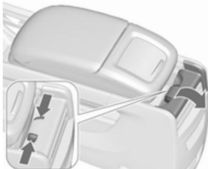
Enfoncer les deux cliques et replier le mécanisme de verrouillage sur l'arrière de l'accoudoir.
