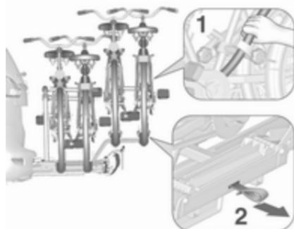
Maintenir le cadre (1) du vélo le plus en arrière avec une main et tirer sur la boucle (2) pour la désengager.
