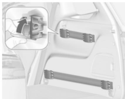
Ouvrir la plaque de fixation, placer l'adaptateur dans la rainure supérieure et inférieure du rail et les amener aux endroits voulus. Basculer la plaque de fixation vers le haut pour
