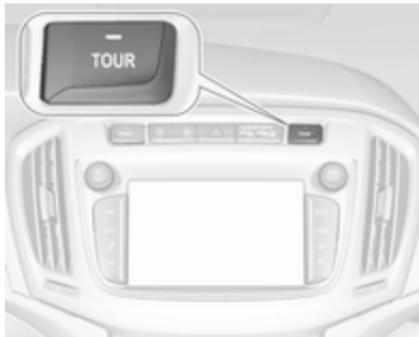
Le réglage des systèmes est adapté à un style de conduite plus confortable.
