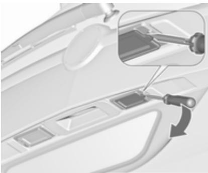
1. Introduire un tournevis dans le creux du couvercle, appuyer sur le côté et libérer le ressort. Retirer le couvercle.
