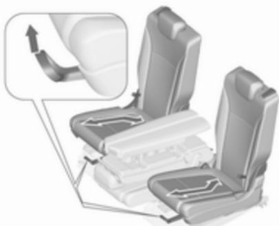
En position lounge, les sièges latéraux peuvent également être déplacés transversalement, lorsque le dossier du siège central central est replié pour former un accoudoir.
