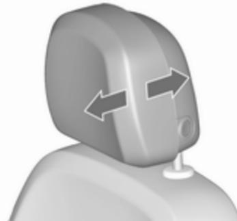
Pour procéder au réglage horizontal, tirer l'appui-tête vers l'avant. Il s'encliquette dans plusieurs positions.
