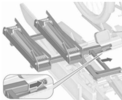
1. Attacher l'adaptateur sur le système de transport arrière comme illustré.
