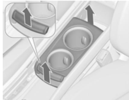
Tirer la manette à l'avant du porte-gobelets et le retirer verticalement de la console.
