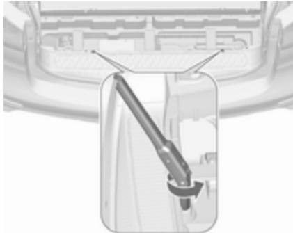
3. Poser la clé de roue sur un boulon hexagonal et la tourner dans le sens anti-horaire jusqu'à ce qu'une certaine résistance soit ressentie.
