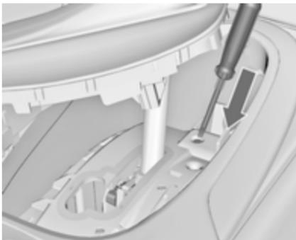
3. Enfoncer le levier de déverrouillage et déplacer le levier sélecteur hors de la position P ou N. Si ces positions sont à nouveau engagées, le levier sélecteur se verrouillera à nouveau dans cette position. Faire corriger la cause de la coupure de courant par un atelier.
