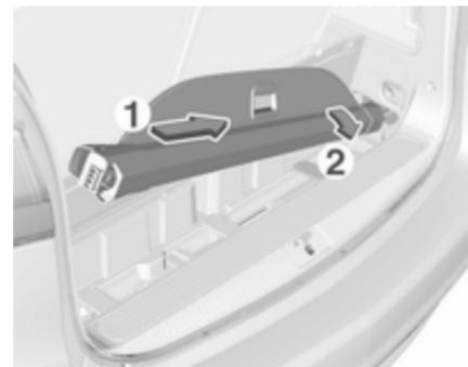
Insérer le cache-bagages dans l'ouverture sur le côté droit du rangement (1) et le tourner jusqu'à ce que la poignée repose à plat sur le logement (2).
