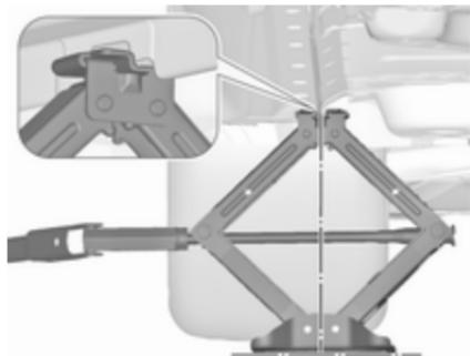
5. Régler le cric à la hauteur requise. Le positionner directement sous le point de levage de manière telle qu'il ne glisse pas.
