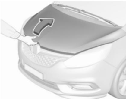
Déplacer le verrou de sécurité sur le côté gauche du véhicule et ouvrir le capot.
