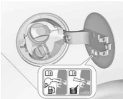
L'inhibiteur de carburant garantit que la trappe du goulot de remplissage de carburant ne peut être ouvert qu'au moyen d'une buse pour carburant diesel ou d'un entonnoir pour appoint d'urgence.
