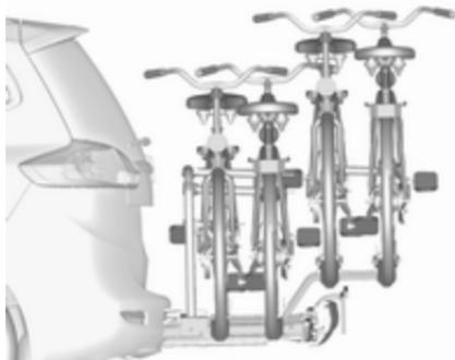
Le système de transport arrière (système Flex-Fix) permet de fixer deux bicyclettes au support de transport extensible intégré dans le plancher du véhicule. Il est possible de fixer deux vélos supplémentaires sur un adaptateur. Le transport d'autres objets n'est pas autorisé.
