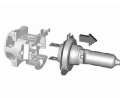
3. Retirer l'ampoule du connecteur enfichable en tirant.
