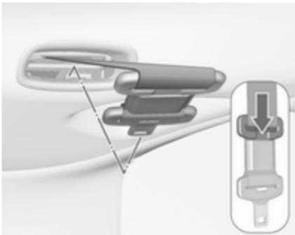
Pousser le verrou plat supérieur dans la fixation. Replier les verrous plats assemblés contre la sangle de ceinture.
