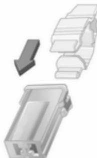
Placer la pince à fusibles par le haut ou le côté sur les différents types de fusibles et retirer le fusible.
