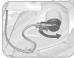
1. Tourner la douille d'ampoule dans le sens anti-horaire et l'enlever du réflecteur.
