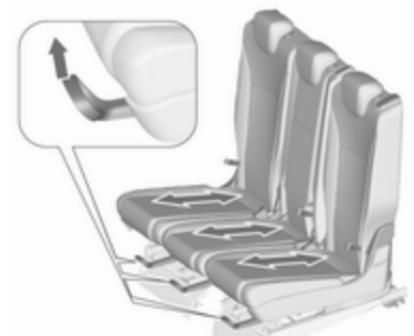
En position normale, les trois sièges de la deuxième rangée de sièges peuvent être indépendamment déplacés longitudinalement.
