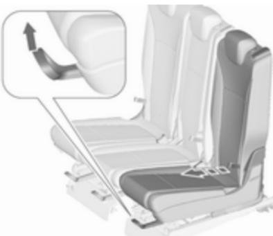
Lors de l'utilisation de systèmes de sécurité pour enfant ISOFIX sur la deuxième rangée de sièges, il est conseillé de régler le siège latéral correspondant à la troisième encoche à partir de la position arrière, pour les sièges de base. Le siège lounge, si le véhicule en est doté, doit être en position normale ▷ 45.
