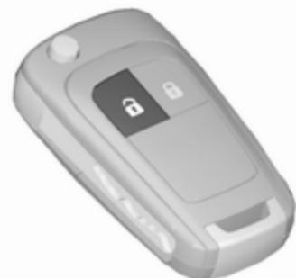
Appuyer sur quand le contact est coupé. Le hayon est débloqué pour être déverrouillé et ouvert en touchant le commutateur tactile sous la poignée.
