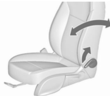
Tirer le levier, régler l'inclinaison et relâcher le levier. Laisser le dossier s'encliquer de manière audible.
