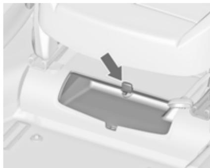
Une boîte de rangement est disposée sous le siège du passager. Faire glisser la molette pour ouvrir ou fermer la boîte. Charge maximale : 1,5 kg.
