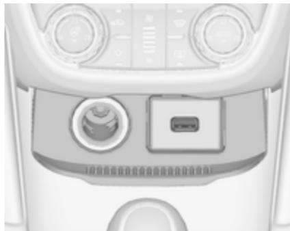
Une prise de courant 12 Volt est placée dans la console avant. Rabattre le couvercle vers le bas.
