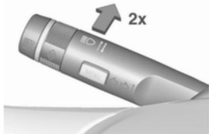
Les feux de route automatiques sont allumés en poussant deux fois le levier de clignotant lorsque le véhicule roule à une vitesse supérieure à 40 km/h.
