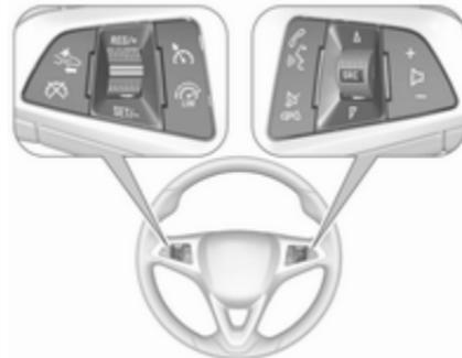
L'Infotainment System, certains systèmes d'assistance au conducteur et un téléphone mobile connecté peuvent être commandés à partir du volant.
