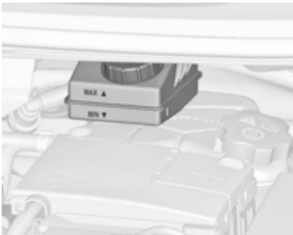
Le niveau de liquide de frein doit se situer entre les repères **MIN** et **MAX**. Si le niveau de liquide est en dessous de la valeur **MIN**, contacter un atelier. Liquide de frein/ d'embrayage ⇨ 333.
