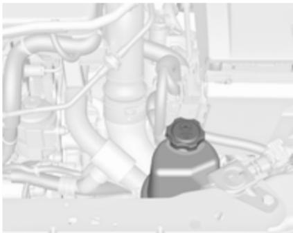
Le niveau du liquide de direction assistée ne doit normalement pas être vérifié. Si un bruit inhabituel est audible pendant l'utilisation du volant ou si la direction réagit de manière inhabituelle, demander l'aide d'un atelier.
