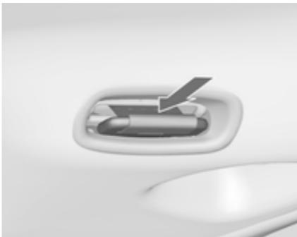
L'introduire dans la fixation de ceinture de sécurité dans le toit, avec le verrou plat inférieur tourné vers l'avant.
