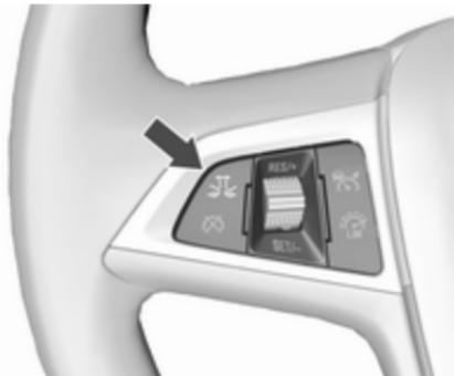
Appuyer sur ; le réglage actuel est affiché dans le centre d'informations du conducteur. Appuyer sur de nouveau pour modifier la sensibilité de l'alerte. Le réglage est également affiché sur la ligne supérieure du centre d'informations du conducteur.
