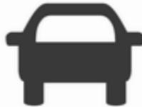
Le témoin de véhicule à l'avant allumé en vert est affiché lorsque le système détecte un véhicule sur la voie de circulation.
