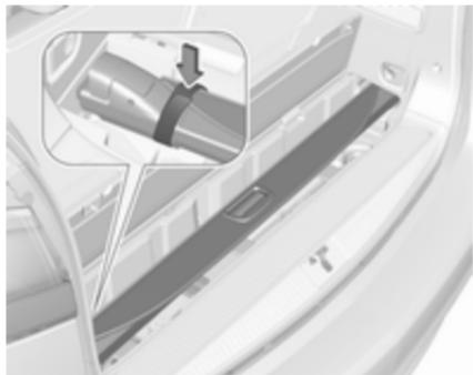
Fixer le cache-bagages dans le compartiment de rangement avec une bande Velcro.
