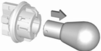
2. Retirer l'ampoule de la douille en tournant dans le sens anti-horaire et en tirant.
