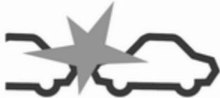
Si un véhicule directement devant est approché trop rapidement, un carillon d'avertissement retentit et une alarme est affichée sur le centre d'informations du conducteur.
