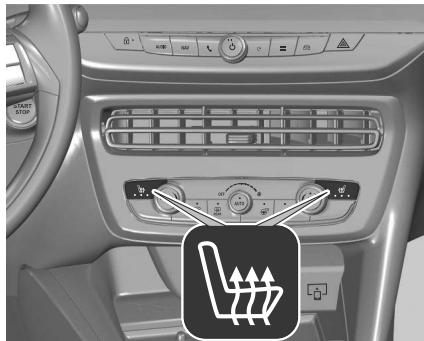
Selon le chauffage voulu, appuyer une ou plusieurs fois sur du siège correspondant. Le témoin dans le bouton indique le réglage sélectionné. Le chauffage fonctionne uniquement lorsque la température extérieure est inférieure à 20°C. Une utilisation prolongée au réglage maximum n'est pas recommandée pour les personnes à peau sensible. Système Stop/Start  $\Rightarrow$  page 88
