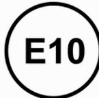
N'utiliser que des carburants conformes à la norme européenne EN 228 ou
