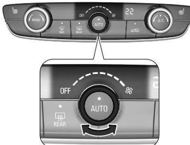
Régler le débit d'air en tournant le bouton rotatif sur la vitesse souhaitée. Le régime du ventilateur peut également être modifié au menu des réglages de climatisation.
