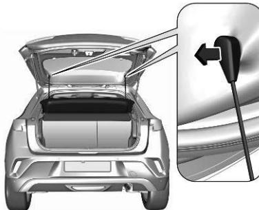
Décrocher les sangles de fixation du hayon.
