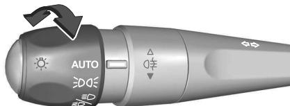
Quand la fonction de commande automatique des feux est activée, le système bascule automatiquement entre les feux de jour et les phares, en fonction des conditions d'éclairage extérieur et des informations communiquées par le système d'essuie-glace.
