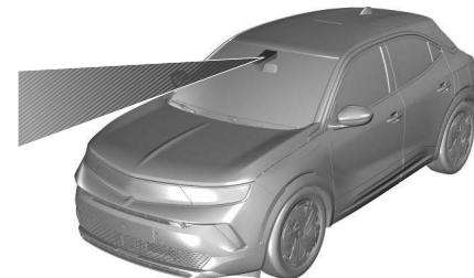
Le système d'avertissement de franchissement de ligne aide le conducteur à éviter une sortie de voie involontaire. La caméra frontale observe les bords de la route, ainsi que les marquages des voies entre lesquelles circule le véhicule. Si le véhicule franchit un bord de route ou un marquage de voie, le système avertit le conducteur. Le système ne détecte pas une sortie de voie involontaire lorsque les clignotants sont actionnés et pendant quelques secondes après leur extinction.
