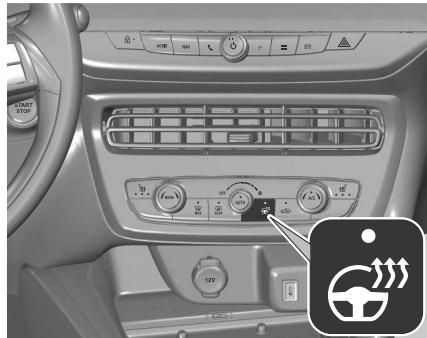
Par temps froid, cette fonction chauffe la partie circulaire du volant. Elle est activable lorsque la température extérieure est inférieure à 20 °C. Activer le chauffage en appuyant sur
