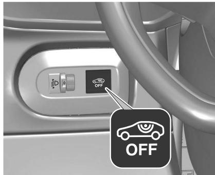
Arrêter la surveillance de l'habitacle et de l'inclinaison du véhicule quand des personnes ou des animaux restent dans le véhicule, en raison de la grande quantité de signaux ultrasoniques et de leurs mouvements déclenchant l'alarme.
