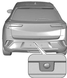
La caméra arrière aide le conducteur à reculer en affichant une vue de la zone derrière le véhicule. Elle permet d'afficher les alentours du véhicule dans une image à quasi 135° à l'écran d'information.
