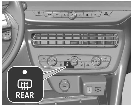
Pour les enclencher, appuyer sur . Le chauffage s'arrête automatiquement après un certain temps en fonction de la température extérieure.
