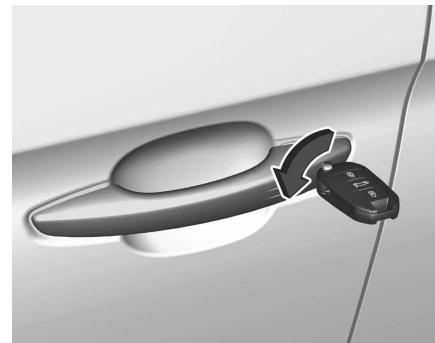
Déverrouiller manuellement la porte avant gauche en introduisant et en tournant la clé dans le bâillet de la serrure.
