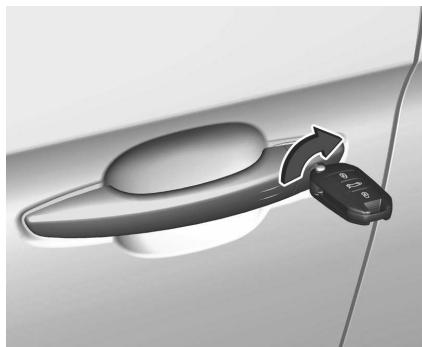
Verrouiller manuellement la porte avant en introduisant et en tournant la clé dans le bâillet de la serrure.
