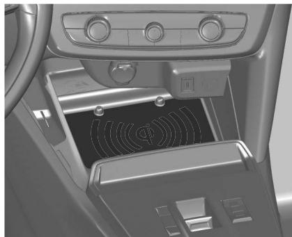
Ce système recharge sans fil des appareils portables tels que les smartphones, en utilisant le principe de l'induction magnétique, selon la norme Qi.
