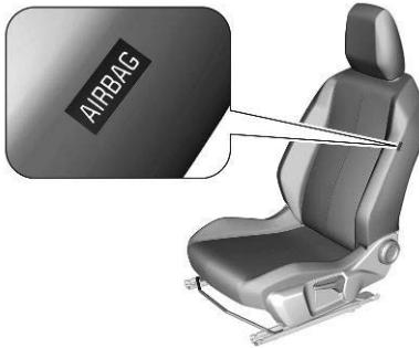
Le système d'airbags latéraux se compose d'un airbag dans chacun des dossier de siège avant.
