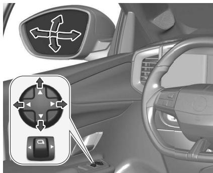
Sélectionner le rétroviseur extérieur concerné en appuyant sur
