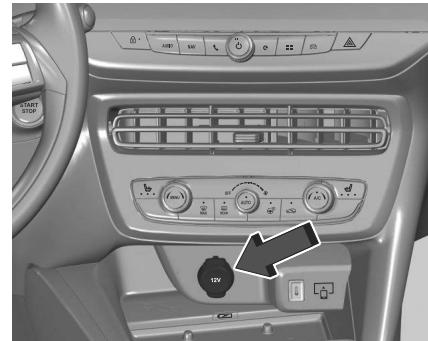
La puissance maximale absorbée ne doit pas dépasser 120 W.
