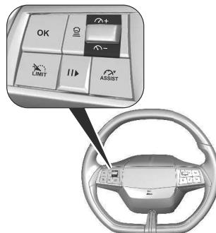
Si le système est actif, la vitesse présélectionnée peut être modifiée en appuyant sur + pour l'augmenter ou sur - pour la diminuer. Une pression courte modifie la vitesse de 1 km/h. Une pression longue modifie la vitesse de 5 km/h.
