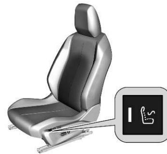
Activer la fonction de massage du dos en appuyant sur . L'activation est signalée par l'éclairage de la LED dans le bouton. La fonction de massage est activée pendant une période d'une heure. Pendant ce temps, un massage est effectué en six cycles entrecoupés de pauses.
