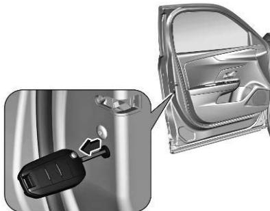
Pour verrouiller les autres portes, ouvrir les portes arrière. S'assurer que la sécurité enfants est désactivée. Insérer la clé délicatement et la tourner vers le côté intérieur des portes. Ensuite, retirer la clé. Fermer les portes. La trappe de remplissage de carburant et le hayon ne sont probablement pas verrouillés.
