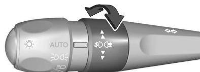
Tourner la molette de réglage vers l'avant/l'arrière pour allumer/éteindre. Il doit être actionné à l'aide du levier à gauche du volant, en tournant la section avec le symbole  $\text{J}\ddot{\text{a}}$ .
