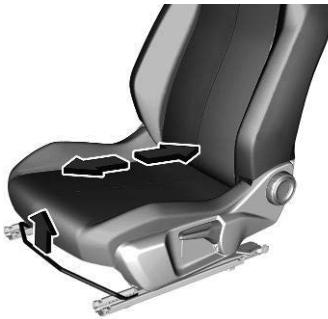
Tirer la poignée, déplacer le siège et relâcher la poignée. Essayer de déplacer le siège d'avant en arrière pour s'assurer qu'il est bien verrouillé en place.
