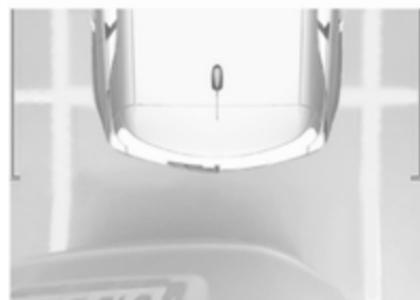
La caméra enregistre les environs du véhicule pendant la manœuvre pour reconstruire une vue depuis le haut de l'arrière ou de l'avant du véhicule dans son environnement proche. Le véhicule peut alors être manœuvré autour des obstacles proches. Cette
