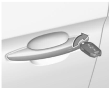
Verrouiller manuellement la porte du conducteur en introduisant et en tournant la clé dans le bavette de la serrure.
