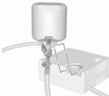
4. Visser le flexible d'air du compresseur sur le raccord sur la bouteille de produit d'étanchéité.
