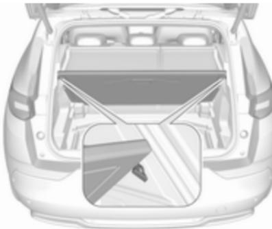
Pour maintenir le cache-bagages en position verticale, le soulever au-delà des butées rétractables.
