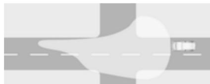
Activés automatiquement à une vitesse maximale d'environ 55 km/h et en cas de lumière ambiante extérieure. Le faisceau lumineux est large et symétrique. Si la vitesse est inférieure à 30 km/h, les phares pivotent légèrement vers l'extérieur pour permettre une reconnaissance plus précoce des piétons et des objets de chaque côté de la route. Un type spécial de faisceau lumineux permet d'éviter d'éblouir les autres usagers de la route.
