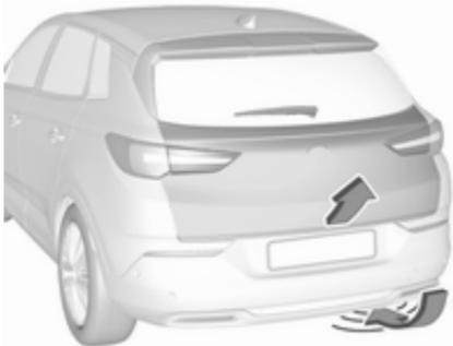
Pour ouvrir ou fermer le hayon, avancer et reculer le pied sous le pare-chocs arrière dans la zone au-dessous de la plaque d'immatriculation. La clé doit être à une portée de 1 m. Ne pas maintenir le pied plus longtemps ou le déplacer plus lentement sous le pare-chocs. La clé électronique doit se trouver à l'extérieur du véhicule dans un rayon d'environ 1 m du hayon.
