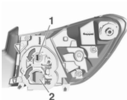
7. Séparer l'ampoule de la douille d'ampoule et remplacer l'ampoule.
