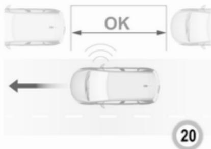
Lorsqu'un emplacement libre est détecté, une information visuelle en retour apparaît sur l'affichage d'informations et un premier signal sonore est émis. Rouler lentement en avant. Lorsque le second signal sonore retentit, arrêter le véhicule, sélectionner la marche arrière, lâcher le volant de direction et commencer à se déplacer doucement. Une rétroaction visuelle est transmise dans l'affichage d'informations.
