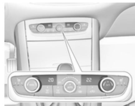
Appuyer sur **A/C** pour mettre le refroidissement en marche. L'activation est signalée par l'allumage de la diode du bouton. Le refroidissement ne fonctionne que lorsque le moteur est en
