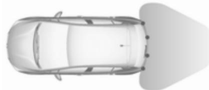
Le système fonctionne avec des capteurs ultrasoniques de stationnement dans le pare-chocs arrière.
