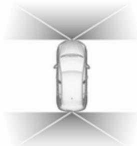
La vue à 180° facilite le recul hors d'un emplacement de stationnement, rendant possible d'observer l'approche des véhicules, des piétons et des cyclistes. Cette vue n'est pas recommandée pour une manœuvre complète. Ceci se compose de trois zones : gauche 1, centre 2 et droite 3. Cette vue est disponible uniquement depuis le menu de sélection de vue.
