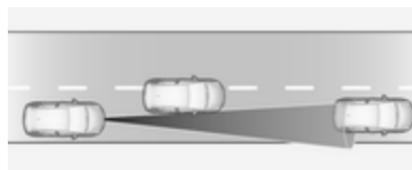
Si un autre véhicule entre dans la même voie de circulation, le régulateur de vitesse adaptatif considérera le véhicule lorsqu'il est complètement sur votre voie. Être prêt à agir et enfoncez la pédale de frein, si un freinage plus rapide est nécessaire.
