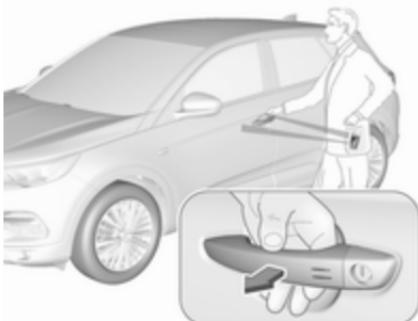
La clé électronique doit se trouver à l'extérieur du véhicule dans un rayon d'environ 1 m du côté de la porte concernée.
