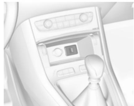
Un port USB se trouve derrière le couvercle de rangement. Appuyer sur le couvercle pour l'ouvrir.
