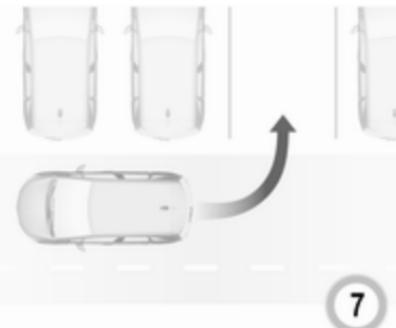
Se déplacer d'avant en arrière comme demandé en observant les avertissements de l'aide au stationnement et en prêtant attention aux signaux sonores jusqu'à ce que la fin de la manœuvre soit indiquée. À la fin,
