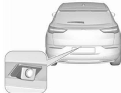
La caméra est montée dans le hayon. La zone affichée par la caméra est limitée. La distance de l'image qui s'affiche sur l'écran est différente de la distance réelle.
