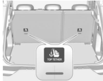
En plus des supports de montage ISOFIX, attacher la sangle Top-Tether aux ancrages Top-Tether.
