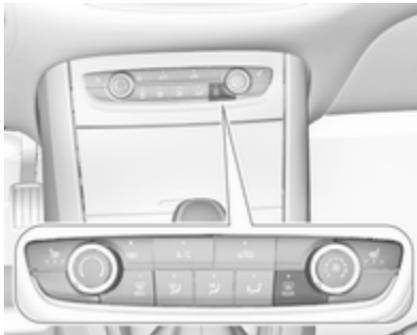
Pour les enclencher, appuyer sur
