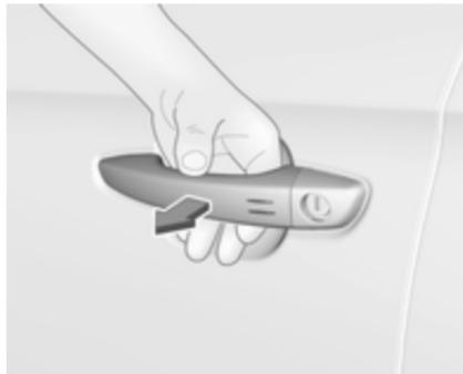
Passer la main derrière la poignée de porte de l'une des portes avant pour déverrouiller le véhicule ou appuyer sur le bouton du hayon.
