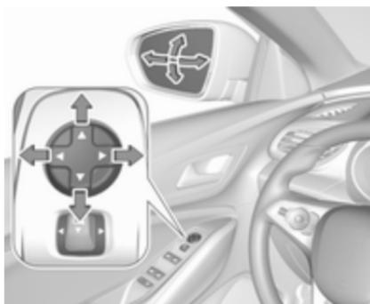
Selectionner le rétroviseur extérieur concerné en appuyant sur le bouton de rétroviseur vers la gauche ou la droite.
