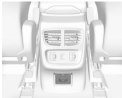
Une prise de courant 230 V peut également se trouver dans la console arrière.
