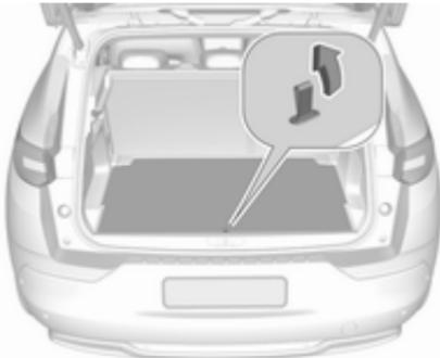
Le recouvrement de plancher arrière peut être soulevé et déposé. Soulever le couvercle au niveau de la boucle et l'enlever.
