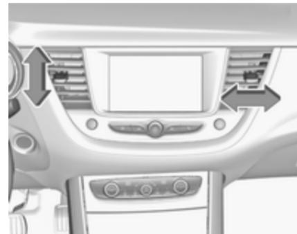
Régler la direction du flux d'air en faisant basculer et pivoter les lames.
