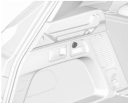
Une autre prise de courant 12 V se trouve sur la paroi gauche du coffre. La puissance maximale absorbée ne doit pas dépasser 120 W.
