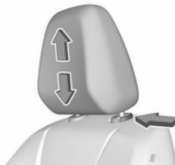
Appuyer sur le bouton de déverrouillage, régler la hauteur, verrouiller.
