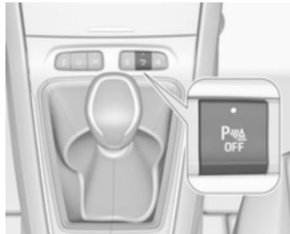
Le système est désactivé lorsque la marche arrière est désengagée. Appuyer sur  $\text{PARK OFF}$  pour désactiver manuellement le système. La diode du bouton s'allume lorsque le système est désactivé. Si le système a été désactivé manuellement, il n'est pas réactivé automatiquement lors de la suivante mise du contact du véhicule.
