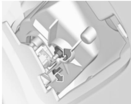
2. Desserrer l'écrou de fixation du bloc optique à l'aide d'une clé à douille ou d'une douille.
