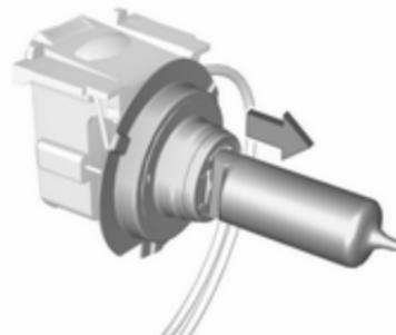
3. Séparer l'ampoule de la douille d'ampoule et remplacer l'ampoule.
