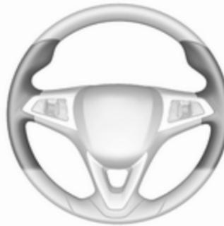
Les zones recommandées pour tenir le volant sont chauffées plus rapidement et à une température plus élevée que le reste du volant.
