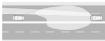
Les feux de route automatiques comprennent un mode pour autoroute spécial. En cas de circulation à plus de 115 km/h sur autoroute, le faisceau lumineux se raccourcit pour ne pas éblouir la circulation en sens inverse. Lorsque vous suivez des véhicules en avant ou de passage, l'éblouissement pour ces véhicules est réduit.
