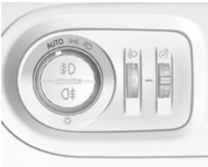
Quand la fonction de commande automatique des feux est activée et que le moteur tourne, le système bascule automatiquement entre les feux de jour et les phares, en fonction des conditions d'éclairage extérieur et des informations communiquées par le système d'essuie-glaces.
