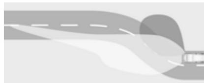
Des DEL particulières, basées sur l'angle de braquage et la vitesse, sont en plus déclenchées pour améliorer l'éclairage dans les virages. Cette fonction est activée à des vitesses comprises entre 40 km/h et 70 km/h.
