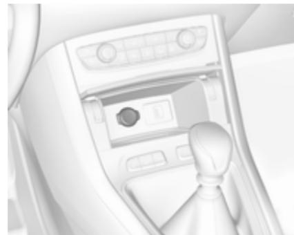
Une prise de courant 12 V se trouve derrière le couvercle de rangement. Appuyer sur le couvercle pour l'ouvrir.
