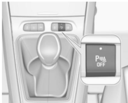
Le système est prêt à fonctionner lorsque la diode du bouton d'aide au stationnement **P OFF** est allumée.
