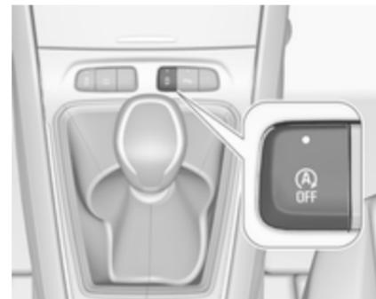
Pour désactiver le système Stop/Start manuellement, appuyer sur . La désactivation est indiquée lorsque la DEL dans le bouton s'allume.
