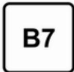
Carburant diesel conforme à la norme EN590 mélangé à un biocarburant conforme à la norme EN14214 (pouvant contenir jusqu'à 7 % d'ester méthylique d'acide gras).
