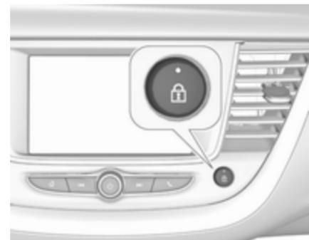
Appuyer sur  $\text{④}$  pour verrouiller. La diode du bouton s'allume.
