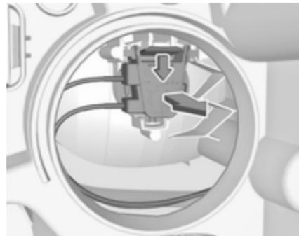
2. Pousser le clip de retenue vers le bas et tirer la douille d'ampoule vers l'arrière.
