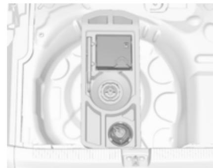
Le kit de réparation des pneus se trouve dans le coffre sous le couvercle de plancher.
