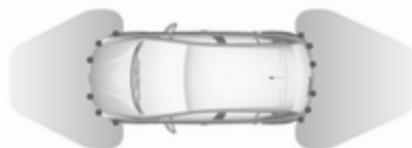
Le système avancé d'assistance au stationnement est toujours associé à l'aide au stationnement avant-arrière.
