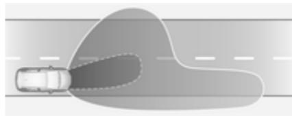
Commandé par l'essuie-glace ou le détecteur de pluie. Le large faisceau lumineux - légèrement pivoté vers l'extérieur - permet d'améliorer l'orientation en bord de route. L'intensité du faisceau d'éclairage de longue portée est augmentée pour reconnaître les objets et les marquages sur le côté de la route du passager avant et les obstacles sur la voie malgré les conditions météorologiques. En abaissant la réflexion sur les chaussées mouillées, la circulation en
