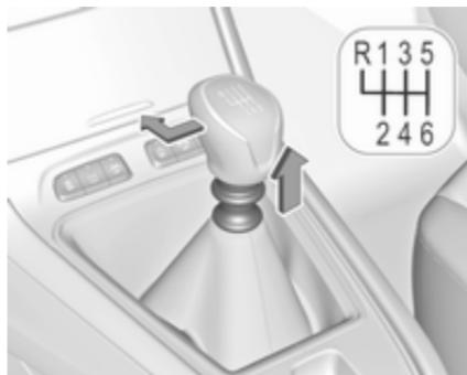
Pour engager la marche arrière d'une boîte de vitesses à 6 rapports, enfoncez la pédale d'embrayage, tirer sur l'anneau sous le levier sélecteur et déplacer le levier sélecteur complètement vers la gauche et l'avant.
