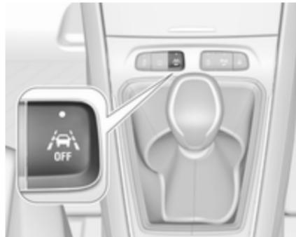
Si le système est activé, la LED intégrée au bouton
