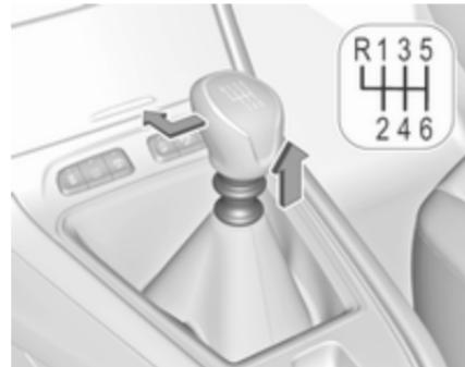
Pour engager la marche arrière d'une boîte de vitesses à 6 rapports, enfoncez la pédale d'embrayage, tirer sur l'anneau sous le levier sélecteur et déplacer le levier sélecteur complètement vers la gauche et l'avant.
