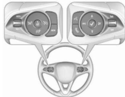
Le régulateur de vitesse et le limiteur de vitesse sont actionnés via les commandes situées sur le côté gauche du volant.
