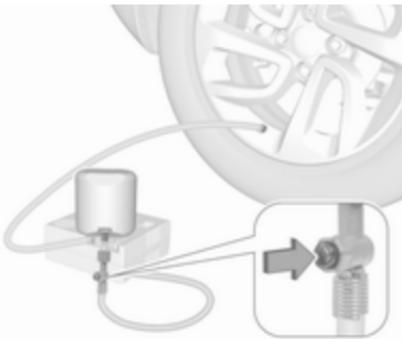
Réduire l'excédent de pression de pneu au moyen du bouton du flexible pneumatique.
