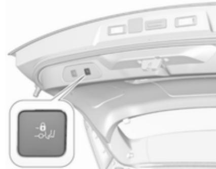
Appuyer sur le bouton
