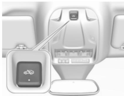
Arrêter la surveillance de l'habitacle et de l'inclinaison du véhicule quand des personnes ou des animaux restent dans le véhicule, en raison de la grande quantité de signaux ultrasoniques et de leurs mouvements déclenchant l'alarme. La désactiver également quand le véhicule est à bord d'un ferry ou d'un train.
