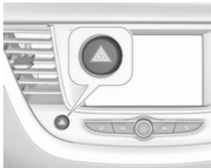
Pour les enclencher, appuyer sur
