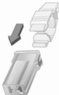
Saisir le fusible avec l'extracteur de fusible, par le haut ou par le côté, selon le type du fusible. Retirer le fusible.
