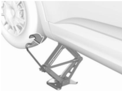
Attacher la clé de roue, aligner correctement le cric et tourner la clé de roue jusqu'à ce que la roue ait quitté le sol.
