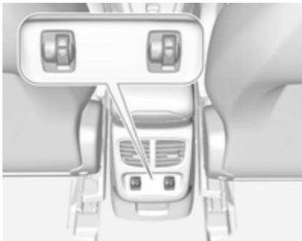
Régler le chauffage du siège en tournant la molette
