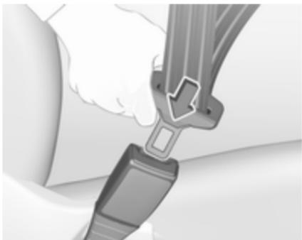
Le port de vêtements larges ou épais gêne la position tendue de la ceinture. Ne pas placer d'objets, comme un sac à main ou un téléphone portable, entre la ceinture et le corps.
