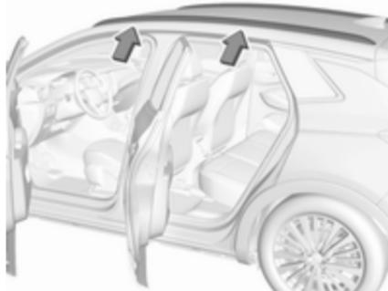
Fixer la galerie de toit dans les rails de toit au-dessus des points de montage situés dans chaque encadrement de porte de la carrosserie du véhicule.
