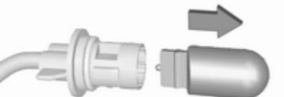
3. Séparer l'ampoule de la douille d'ampoule et remplacer l'ampoule.
