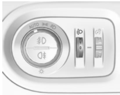
Pour adapter la portée des phares en fonction du chargement du véhicule afin d'éviter l'éblouissement : tourner la molette  $\frac{1}{D}$  dans la position désirée.
