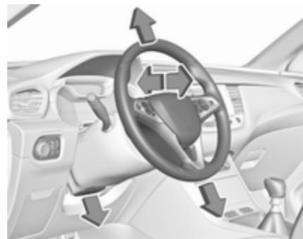
Débloquer le levier, régler le volant puis bloquer le levier et vérifier qu'il est bien verrouillé. Ne régler le volant que lorsque le véhicule est arrêté et la direction débloquée.
