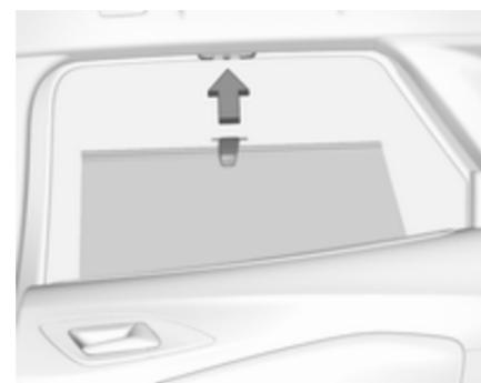
Pour réduire l'exposition au soleil de la deuxième rangée de sièges, relever le store en utilisant la poignée et l'encliquer sur le haut du cadre de porte.
