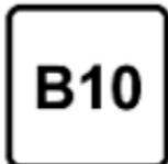
Carburant diesel conforme à la norme EN16734 mélangé à un biocarburant conforme à la norme EN14214 (pouvant contenir jusqu'à 10 % d'ester méthylique d'acide gras).
