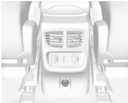
Une prise de courant 12 V est également être située dans la console arrière.
