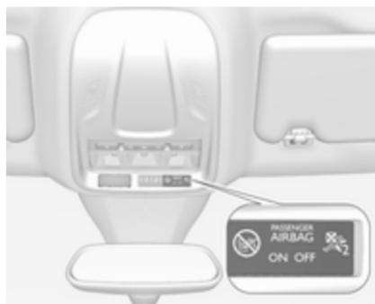
Si le témoin s'allume pendant environ 60 secondes après avoir mis le contact, le système d'airbags de passager avant se déploiera en cas de collision.
