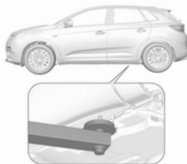
Position de centrage du bras porteur arrière du pont élévateur sous le point de levage du véhicule.
