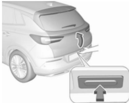
Pour ouvrir le hayon, presser le bouton du hayon jusqu'à ce que le hayon commence à se déplacer. Si le véhicule est verrouillé, la clé électronique doit se trouver à l'extérieur du véhicule dans un rayon d'environ 1 m du hayon.
