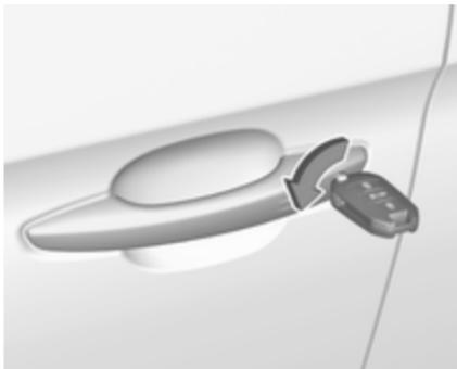
Déverrouiller manuellement la porte du conducteur en introduisant et en tournant la clé dans la bavette de la serrure.
