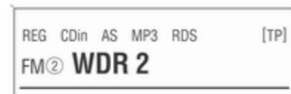
Quand la station actuellement réglée n'est pas une station RDS, la radio recherche automatiquement la station RDS recevable la plus proche pouvant être captée.
