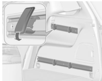
Haken in gewünschter Position in Schienen einsetzen: Dazu Haken in obere Nut der Schiene einsetzen und in untere Nut drücken.
