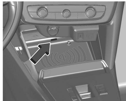
Sobald das Gerät erkannt wird, leuchtet die Kontrollleuchte des Ladegeräts grün. Sie leuchtet während der gesamten Ladezeit der Akkus.
