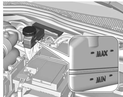
Der Bremsflüssigkeitsstand muss zwischen **MIN** und **MAX** liegen. Wenn der Flüssigkeitsstand unter die **MIN**-Markierung gefallen ist, die Hilfe einer Werkstatt in Anspruch nehmen. Brems- und Kupplungsflüssigkeit  $\Rightarrow$  Seite 175
