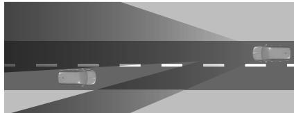
Jede LED auf der rechten bzw. linken Seite wird entsprechend der Verkehrslage speziell zu- oder ausgeschaltet. Das sorgt für die bestmögliche Lichtverteilung, ohne dass Verkehrsteilnehmer geblendet werden.
