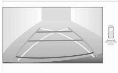
Auf dem Bildschirm wird der Bereich hinter dem Fahrzeug angezeigt. Die senkrechten Linien zeigen die Fahrzeugsbreite bei ausgeklappten Seitenspiegeln an.
