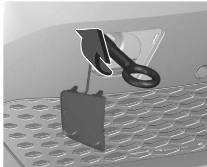
Abschleppöse bis zum Anschlag in waagerechter Stellung einschrauben. Die Abschleppstange an der Abschleppöse befestigen. Die Abschleppöse darf nur zum Abschleppen und nicht zum Bergen des Fahrzeugs verwendet werden. Die Zündung einschalten, um den Betrieb von Bremsleuchten, Hupe und Scheibenwischer zu ermöglichen und, je nach Version, die Lenkradsperre zu lösen.
