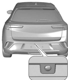
Die Rückfahrkamera unterstützt den Fahrer beim Rückwärtsfahren, indem sie auf dem Display eine Ansicht des Bereichs hinter dem Fahrzeug anzeigt. Das System kann beinahe eine 135°-Ansicht der Fahrzeugumgebung im Informationsdisplay anzeigen.
