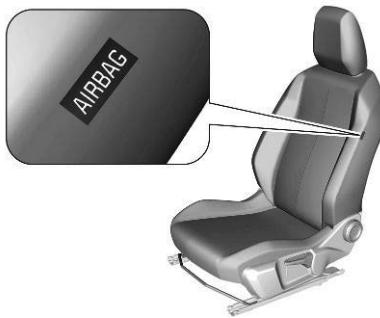
Das Seiten-Airbagsystem besteht aus einem Airbag in jeder Vordersitzlehne. Diese Stellen sind mit dem Wort **AIRBAG** gekennzeichnet.
