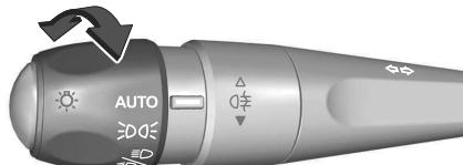
Bei aktiverter automatischer Lichtsteuerung schaltet das System abhängig von den äußereren Lichtverhältnissen und den Informationen des Wischersystems automatisch zwischen Tagfahrlicht und Scheinwerfern um.
