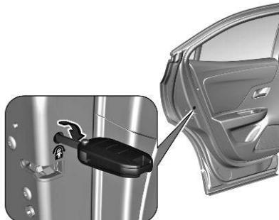
Rote Kindersicherung in der hinteren Tür mit einem Schlüssel in Richtung Fahrzeuginnenraum in die waagerechte
