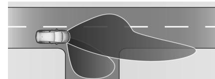
Beim Abbiegen mit bis zu 40 km/h aktiviert. Der Scheinwerfer besteht aus einzelnen LEDs, die den Fahrweg ausleuchten. Diese LEDs werden abhängig vom Lenkeinschlag oder der Aktivierung der Blinker ausgelöst.
