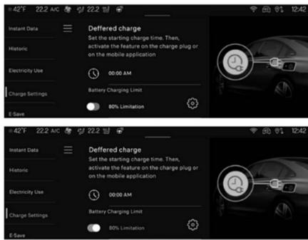
Die Begrenzung des Ladezustands auf 80 % kann im Lademenü auf dem Informationsdisplay eingestellt werden. Wenn diese Funktion aktiviert ist, wird der Ladevorgang automatisch beendet, wenn ein Ladezustand von 80 % erreicht ist. Eine Statusmeldung wird auf dem Kombiinstrument angezeigt.
