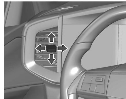
Richtung des Luftstroms durch Kippen und Schwenken der Lamellen einstellen. Zum Schließen der Belüftungsdüse die Lamellen nach außen schwenken. Bei eingeschalteter Kühlung müssen mindestens zwei Belüftungsdüsen geöffnet sein.
