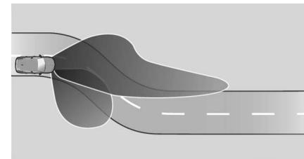
Je nach Lenkwinkel und Geschwindigkeit werden spezielle LED zusätzlich eingeschaltet, um in Kurven das Scheinwerferlicht zu verbessern. Diese Funktion ist bei einer Geschwindigkeit zwischen 40 und 70 km/h aktiviert.
