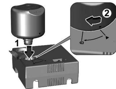
5 Zunächst die Flasche mit dem Dichtmittel in den Kompressor einsetzen und die Dreieckssymbole ausrichten. Dann die Flasche mit dem Dichtmittel nach unten drücken und in die Verriegelungsposition drehen.
