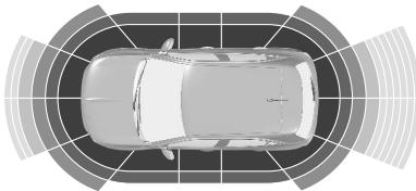
Diese Funktion warnt den Fahrer durch Anzeigen von Hinweisen, wenn Hindernisse seitlich neben dem Fahrzeug erkannt werden. Wenn sich das Hindernis neben dem Fahrzeug befindet und möglicherweise eine Kollision bevorsteht, ertönt ein **akustisches Warnsignal**. Hindernisse seitlich neben dem Fahrzeug werden nur berücksichtigt, wenn sie zuvor von den Parksensoren erkannt und vom System gespeichert wurden.
