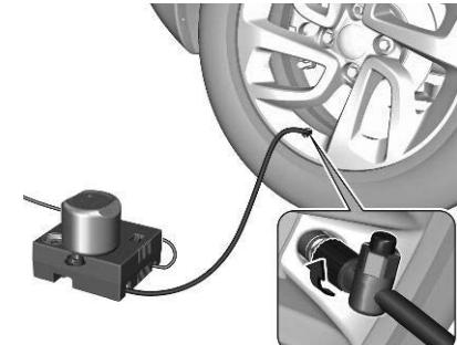
8 Den Einfüllschlauch am Reifenventil anschrauben.
