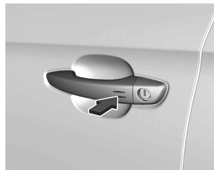
Zum Entriegeln oder Verriegeln den Sensor am Fahrertürgriff berühren.
