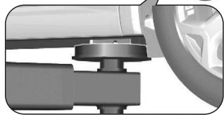
Die Position der hinteren Arme der Hebebühne befindet sich mittig unter den entsprechenden Wagenheberaufnahmen.
