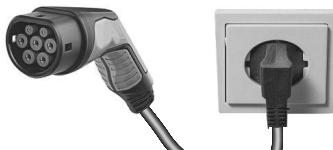
Die Hochvoltbatterie kann an einer Haushaltssteckdose geladen werden. Das Kabel am Ladeanschluss des Fahrzeugs und an der Haushaltssteckdose anschließen.
