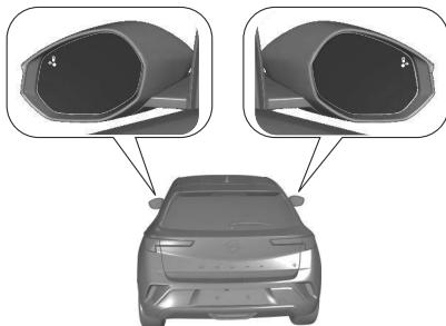
Erkennt das System bei Vorwärtsfahrt ein Fahrzeug im toten Winkel, leuchtet im entsprechenden Seitenspiegel eine LED auf. Wenn die Blinker auf der entsprechenden Seite aktiviert sind, blinkt die LED.
