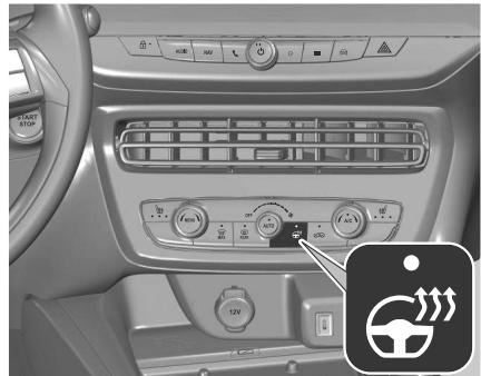
Bei Kälte beheizt diese Funktion den äußeren Teil des Lenkrads.
