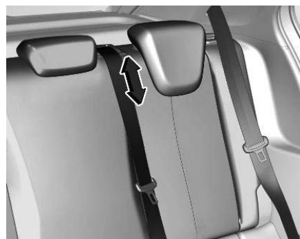
Der Sicherheitsgurt des Mittelsitzes könnte blockiert werden, wenn die Rückenlehne zu schnell hochgeklappt wird. Um den Aufroller zu entsperren, Sicherheitsgurt ca. 20 mm hineindrücken oder herausziehen und dann loslassen.
