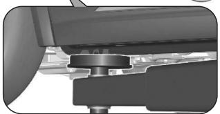
Die Position der vorderen Arme der Hebebühne befindet sich mittig unter den entsprechenden Wagenheberaufnahmen.
