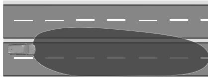
Wird bei einer Geschwindigkeit über 105 km/h aktiviert. Die Leuchtweite wird an die höhere Autobahngeschwindigkeit angepasst. Ohne Gegenverkehr wird die Sicht auf der Fahrzeugseite erhöht. Bei voraufahrenden Fahrzeugen bzw. beim Überholen wird der andere Verkehrsteilnehmer weniger geblendet.
