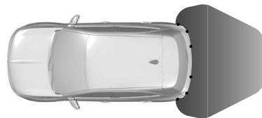
Das System arbeitet mit Ultraschall-Parksensoren im hinteren Stoßfänger.
