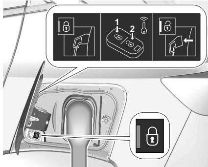
Nach dem Beginn des Ladevorgangs wird der Fahrzeugstecker am Ladeanschluss verriegelt und kann während des aktiven Ladens nicht getrennt werden. Die Kontrollleuchte leuchtet.
