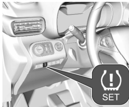
3. Das Reifendruckverlust-Überwachungssystem initialisieren: Bei Fahrzeugen mit Graphic-Info-Display drei Sekunden lang  $\text{SET}$  drücken. Bei Fahrzeugen mit
