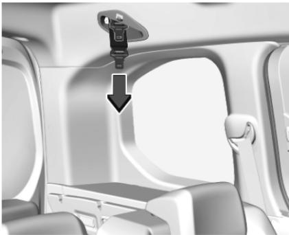
Schließzungen mit dem Sicherheitsgurt aus dem Sicherheitsgurthalter am Dach ziehen.
