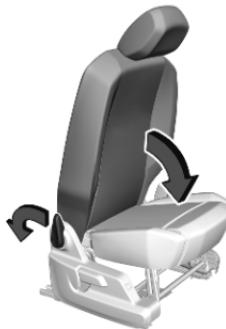
Den Hebel drücken, die Rückenlehne vollständig nach vorne klappen und den Hebel loslassen. Dann die Rückenlehne weiter nach unten drücken, bis sie komplett flach liegt.
