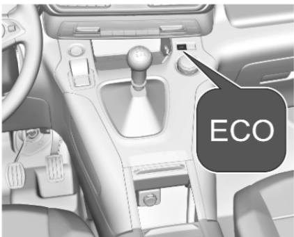
Dieser Modus passt die Einstellungen der Systeme so an, dass der Kraftstoffverbrauch optimiert wird, z. B. durch Anpassung der Schaltzeitpunkte des Automatikgetriebes oder Anpassung der Empfindlichkeit des Gaspedals.
