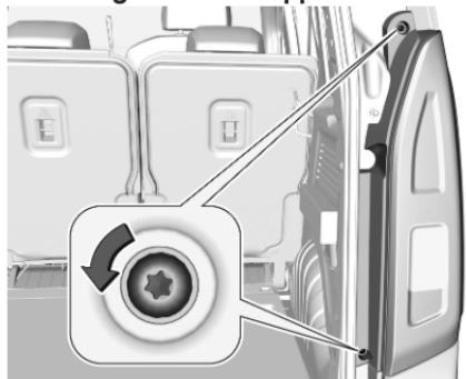
1. Die beiden Schrauben losschrauben und abnehmen.
