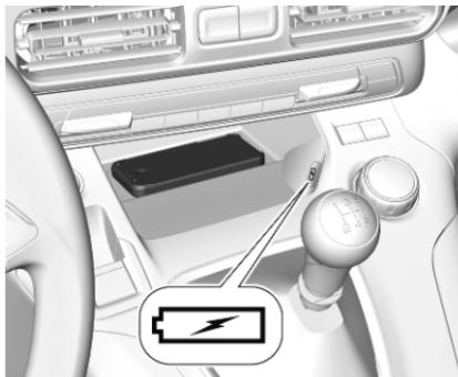
Das zu ladenden mobile Gerät muss mit dem Qi-Standard kompatibel sein, entweder konstruktionsbedingt oder mit Verwendung eines kompatiblen Halters/einer kompatiblen Schale. Die Ladezone ist durch das Qi-Symbol gekennzeichnet.
