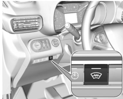
Die Heizung wird durch Drücken auf
