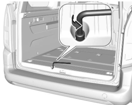
2. Radschlüssel an einer Sechskopfschraube ansetzen. Linksherum drehen, bis der Reserveradhalter so weit abgesenkt ist, dass die Befestigung gelöst werden kann.
