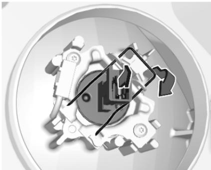
2. Die Federklammer nach rechts schieben, um sie von der Halterung zu lösen. Die Federklammer nach unten schwenken.
