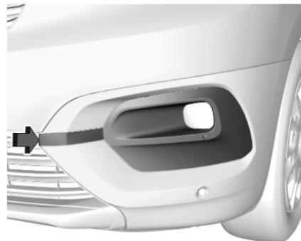
1. Die Spitze eines Schlitzschraubendrehers mit einem Tuch umwickeln, um den Lack zu schützen. Den Schraubendreher in die Aussparung an der Kante der Abdeckung stecken. Die Abdeckung vorsichtig abheben und lösen.
