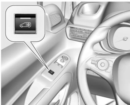
Zum Entriegeln der Heckklappe je nach Version
