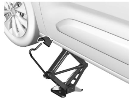
Radschlüssel bei korrekt ausgerichtetem Wagenheber drehen, bis das Rad vom Boden abhebt.
