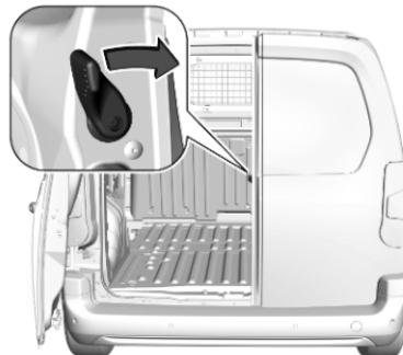
Die rechte hintere Tür wird mit dem Hebel entriegelt.
