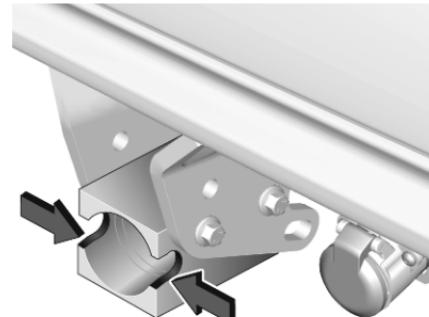
2. Die Kontaktpunkte mit einem weichen, sauberen Tuch reinigen.
