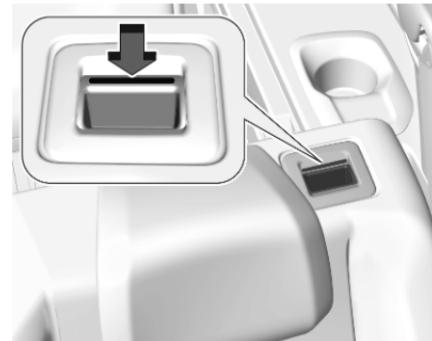
Die Rückenlehnen sind korrekt eingerastet, wenn die rote Markierungen neben dem Entriegelungsgriff nicht mehr sichtbar ist.
