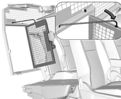
3. Die Klappe mit der Stange sichern.
