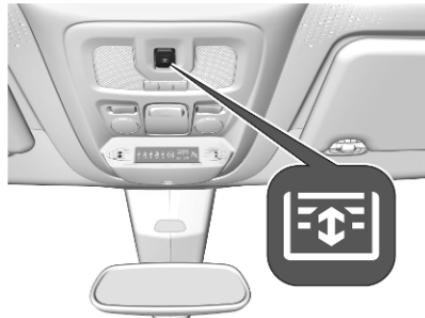
Drücken hinten auf : Das Sonnenrolle wird geöffnet, solange der Schalter betätigt wird.
