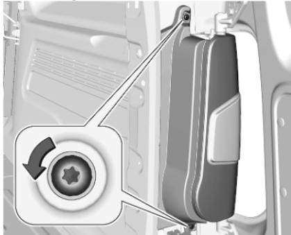
1. Die beiden Schrauben losschrauben und abnehmen.
