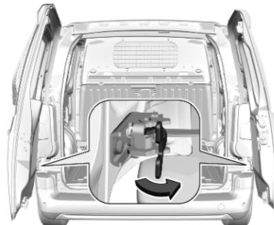
Die Türen werden durch Streben in der 90°-Position gehalten. Um die Türen bis 180° zu öffnen, auf die Arretierung drücken und die Türen in die gewünschte Position schwenken. Vor dem Schließen der Türen sicherstellen, dass die Arretierstreben in der 90°-Position stehen.
