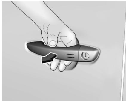
Eine Hand hinter den Türgriff einer der vorderen Türen oder der hinteren Tür führen, um das Fahrzeug zu entriegeln. Alternativ die mittlere Heckklappentaste drücken.
