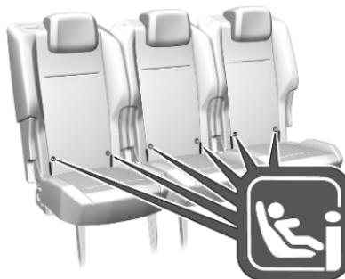
Für das Fahrzeug zugelassene ISOFIX-Kindersicherheitssysteme an den ISOFIX-Befestigungen befestigen. Die speziellen Positionen für ISOFIX-Kindersicherheitssysteme sind in der Tabelle mit ISOFIX gekennzeichnet  $\diamond$  71.
