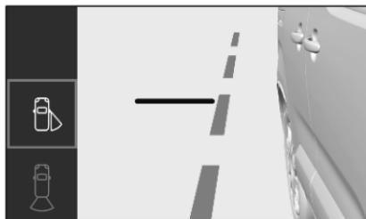
Die Linie markiert eine Entfernung von etwa 4 m zum Rand des Heckstoßfängers.
