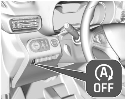
Die Stopp-Start-Automatik lässt sich durch Drücken von
