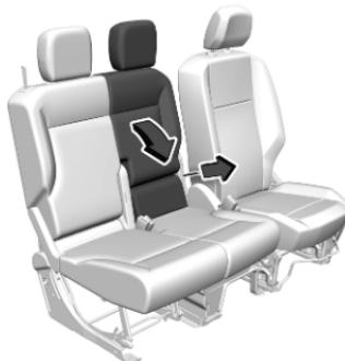
Die Rückenlehne am mittleren Sitz durch Ziehen an der Schlaufe umklappen.
