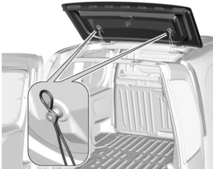
3. Den Widerstandspunkt überschreiten, um die Leiterklappe mit den Stützen zu verriegeln.
