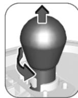
5. Leuchte leicht nach unten drücken, drehen und aus der Leuchtmittelfassung ausbauen. Leuchtmittel wechseln:
