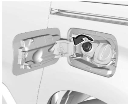
4. Die Schutzkappe vom Einfüllstutzen abschrauben.
