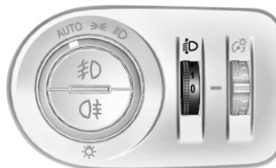
Zur Anpassung der Leuchtweite an die Fahrzeuglast, um Blendwirkung zu reduzieren: Daumenräderchen
