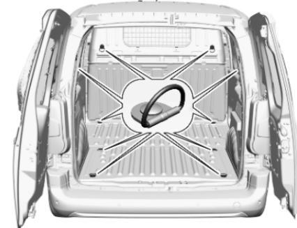
Am Fahrzeugsboden und / oder an der Seitenwand können sich Verzurrösen befinden. Die Anzahl und der Anbringungsort der Verzurrösen können je nach Fahrzeug unterschiedlich sein.
