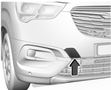
Die Spitze eines Schlitzschraubendrehers mit einem Tuch umwickeln, um den Lack zu schützen. Den Schraubendreher in den Schlitz am unteren Bereich der Abdeckung stecken. Die Kappe vorsichtig lösen. Die Abschleppöse befindet sich beim Wagenwerkzeug  $\diamond$  243.
