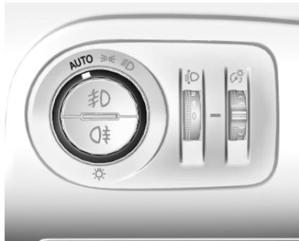
Bei aktiverter automatischer Lichtsteuerung und laufendem Motor schaltet das System abhängig von den äußereren Lichtverhältnissen und den Informationen des Wischersystems zwischen Tagfahrlicht und Scheinwerfern automatisch um.
