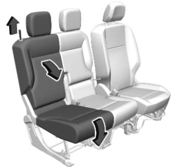
Die äußere Rückenlehne durch Ziehen an der Schlaufe umklappen. Die Rückenlehne nach vorne schwenken, bis der Sitz auf den Fahrzeugschacht abgesenkt ist.
