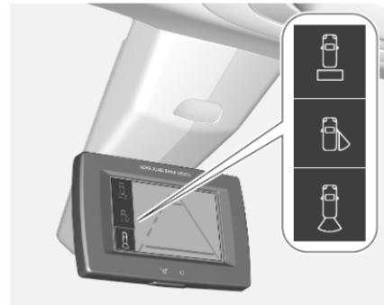
Die Standardansicht nach hinten oder die Sicht auf die Beifahrerseite durch Drücken auf " $\Rightarrow$ " am unteren Rand auswählen.
