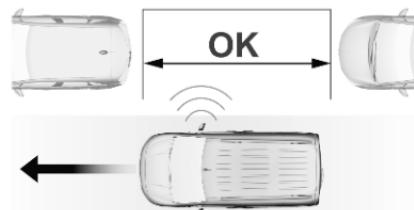
Wenn eine freie Parklücke erkannt wird, wird im Info-Display eine optische Rückmeldung gegeben und es ertönt ein erster Signalton. Langsam vorwärts fahren. Wenn der zweite Signalton ertönt, das Fahrzeug anhalten, den Rückwärtsgang einlegen, das Lenkrad loslassen und langsam anfahren. Im Info-Display wird eine optische Rückmeldung gegeben.
