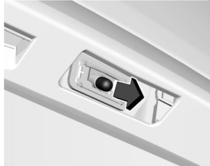
2. Die Lampe aus der Fassung ziehen und wechseln.
