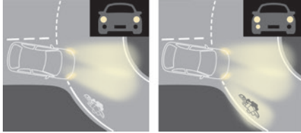
Statik kavşak aydınlatmasız/aydınlatmalı
